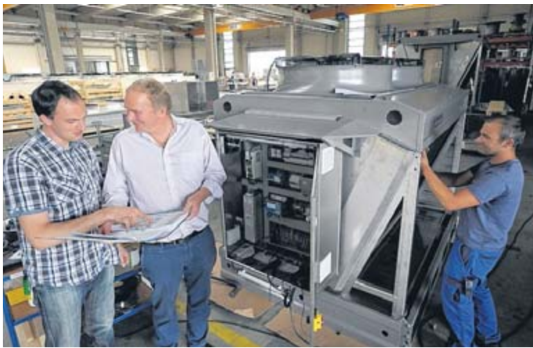
Jörg Reiher (links) und Bernd Löffler an einem hybriden Rückkühler. Dieses neue Thermofin-Produkt wird in Rechenzentren eingesetzt. Rechts im Bild Steve Schwalbe, Teamleiter Produktion.
