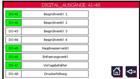
Durch das Betätigen bspw. des Feldes „Wasserventile DO“ gelangt der Anwender in die nächste Ebene, der Zustandsanzeige der jeweiligen I/O Baugruppe.
