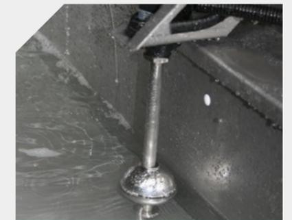
Füllstandsmessung/filling level sensor
