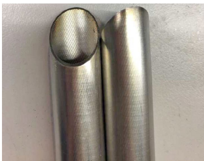
Abbildung 12: Innenberippungen bzw. Einbauten von Kernrohren [4]
