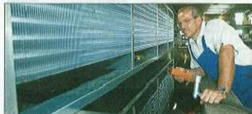
Thermofin-Mitarbeiter Ulrich Mittenzwei prüft die Dichte eines Wärmetauschers im Tauchbecken.
