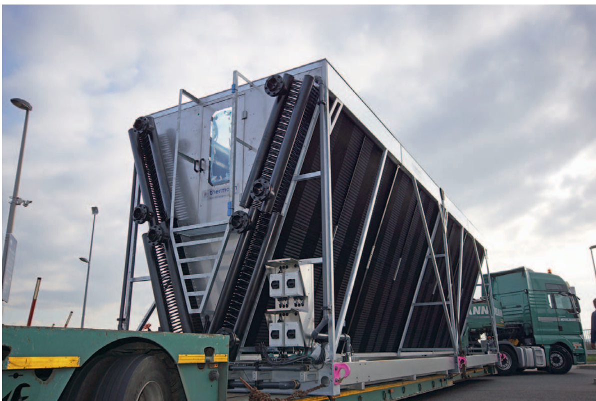
Bei der Zentis GmbH & Co. KG wurde ein Kühler der thermofin-Baureihe „THDD“ installiert. Mit einem Leergewicht von ca. 14 000 kg und Abmessungen von 13,0 x 3,0 x 5,0 m (L x B x H) zählt es zu den größten seiner Bauart.
