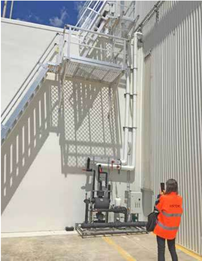
Bild 11: LOGAS-Heißgasabtauung im Feldtest
