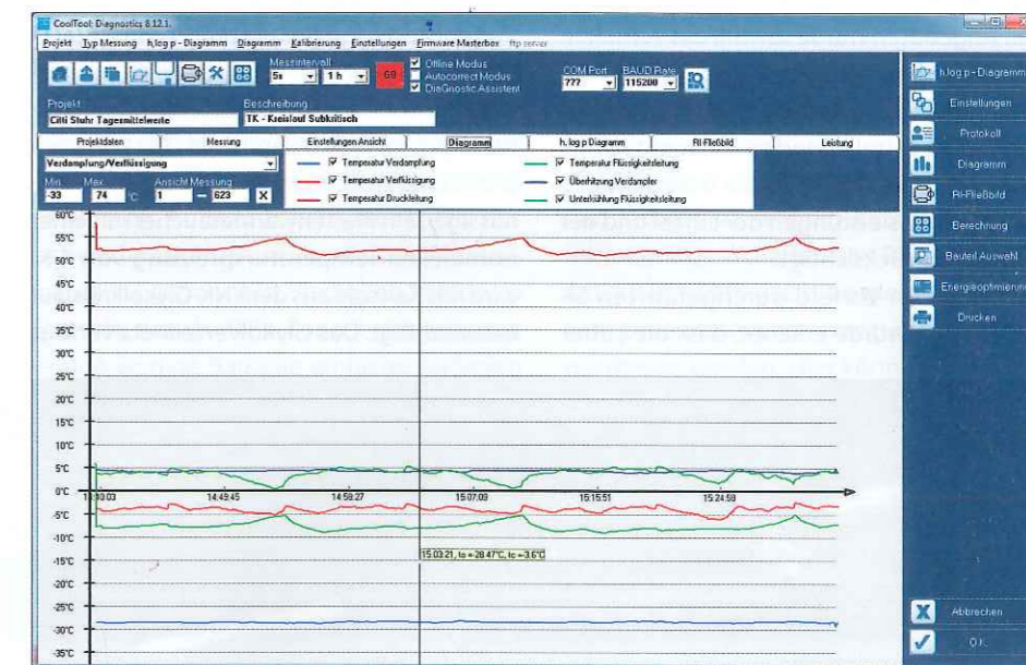
Abb. 4: Aufzeichnung der Betriebszustände: konstante Verflüssigung ohne stark schwankende Drücke im TK-Bereich durch die mit Glykol beaufschlagten Kaskadenkühler
